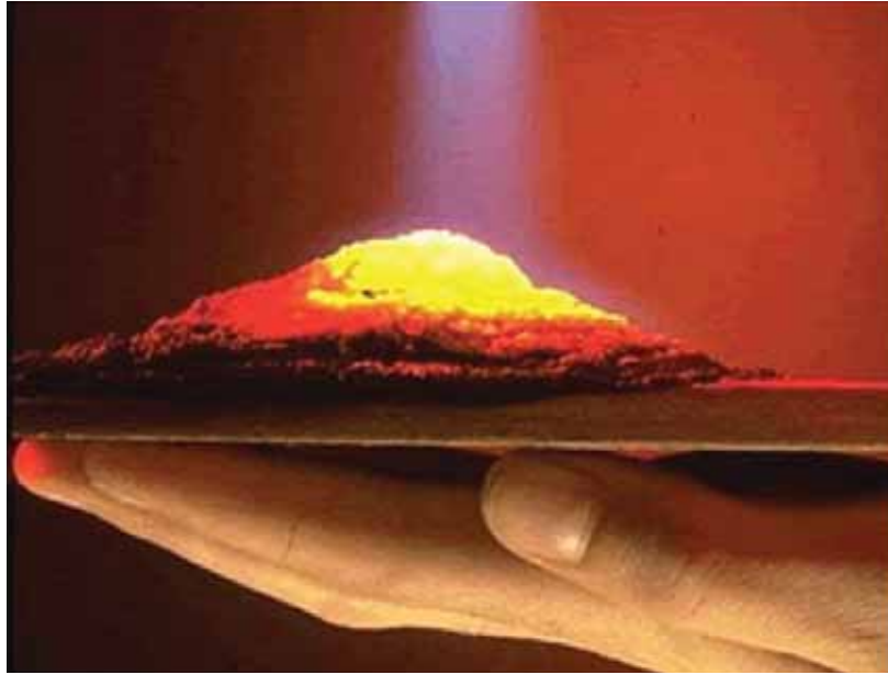
ภาพที่ ๔๖ การขยายตัวของสีทนไฟเมื่อได้สัมผัสความร้อนจากเปลวไฟ
