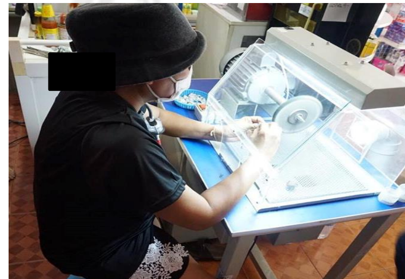
รูปที่ 2 การตรวจวัดปริมาณฝุ่นขนาดเล็กขณะปฏิบัติงานบนสถานการณ์งานขัดเงาเครื่องเงินที่ออกแบบใหม่สรุปผลและการนำไปใช้ประโยชน์
