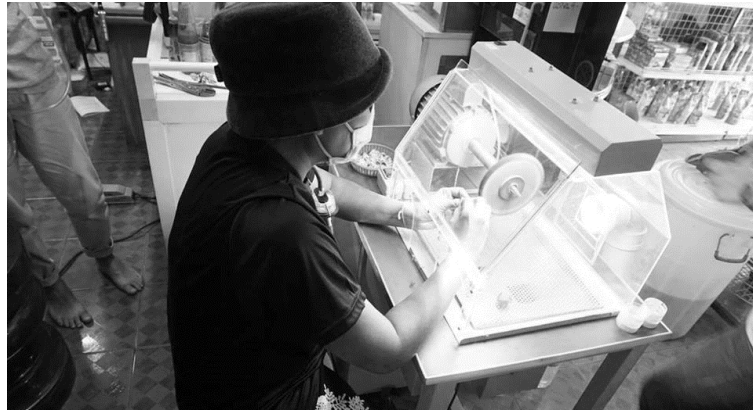
รูปที่ 5 การตรวจวัดปริมาณฝุ่นละอองขนาดเล็กที่เข้าสู่ถุงลมปอดได้ (Respirable dust) ขณะปฏิบัติงานบนสถานีงานเครื่องขัดเงินที่ออกแบบใหม่
