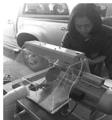
รูปที่ 4 การทดสอบวัดความเร็วลมบริเวณหน้าชุดดูดอากาศ
