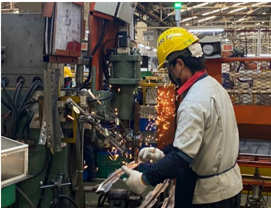
ภาพที่ 1 แสดงสะเก็ดไฟที่เกิดจากงาน Stationary spot welding
