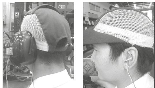
รูปที่ 1 การติดตั้งไมโครโฟนวัดระดับเสียงในหูและนอกหูใต้การสวมครอบหูลดเสียง
