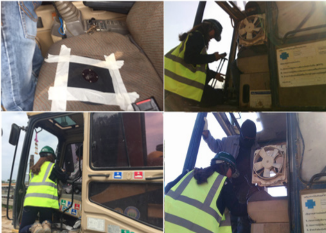
ภาพที่ 1 ภาพการติดตั้งเครื่องวัดแรงสั่นสะเทือน
