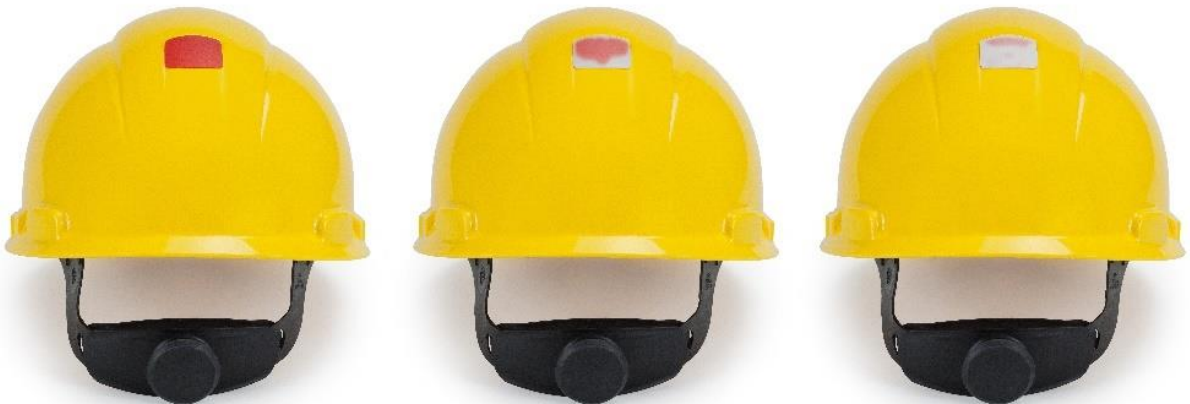
รูปที่ 3 ลักษณะการเปลี่ยนสีของ Uvicator เมื่อสัมผัสรังสี UV
