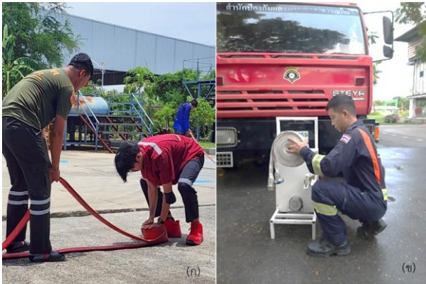
ภาพที่ 2 การม้วนเก็บสายดับเพลิงโดยใช้แรงงานคน (ก) และวิธีการม้วนเก็บสายดับเพลิงด้วยเครื่อง (ข)
